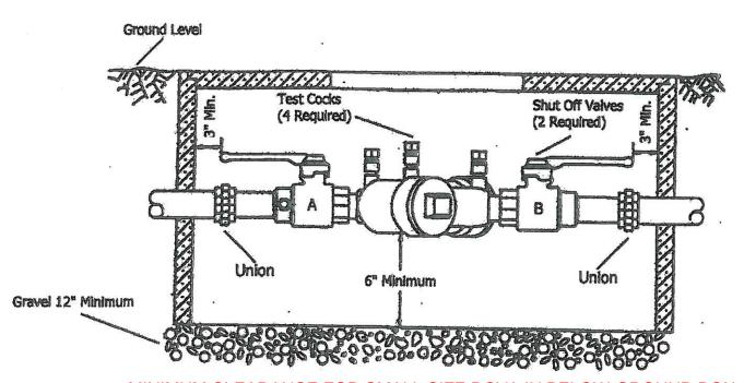
MINIMUM CLEARANCE FOR SMALL SIZE DCVA IN BELOW-GROUND BOX.
